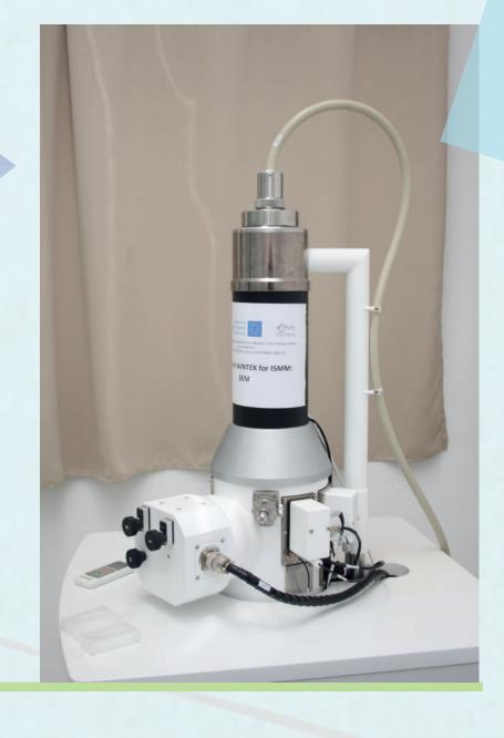
Depuis son apparition, le microscope électronique à balayage (MEB) s'est révélé être un puissant outil de caractérisation des matériaux, en particulier pour l'état de surface, topographie, taille de grains des métaux, observation des défectuosités (fissurations, endommagements, fractures, etc.), porosité, formes et répartition des charges dans les polymères, observation des nanomatériaux ou des cellules biologiques.
